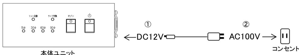
3. 電源スイッチ を押し、ON にして下さい。スイッチの表示灯が点灯し、ファンが回転します。
