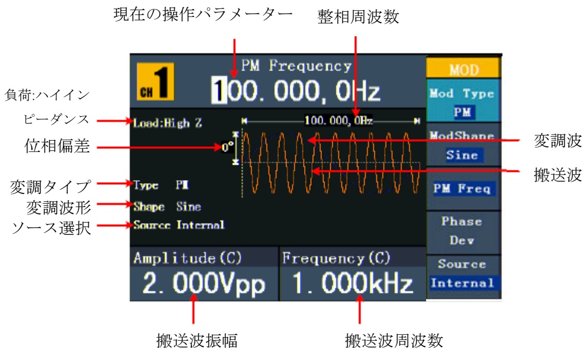
図 5-20 : 位相変調のユーザーインターフェース
