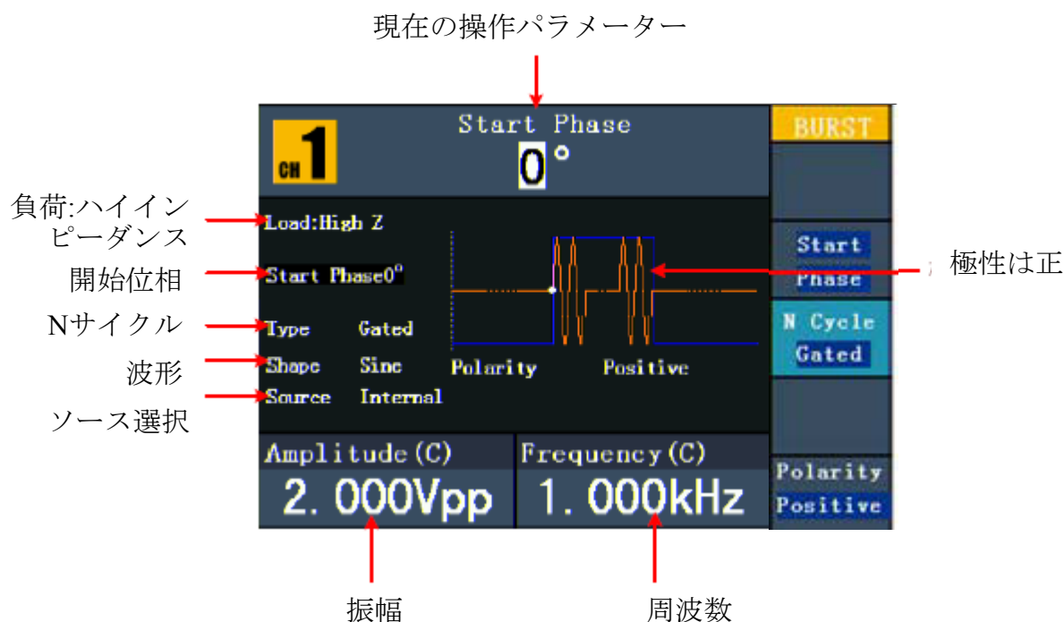
図 5-24 : ゲートパルス列のユーザーインターフェース
