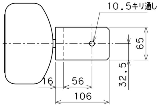
ロードセル取付金具寸法図
