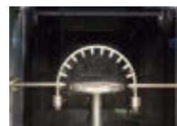
■ オシレーティングチューブ試験 IP コード IPX3・IPX4
