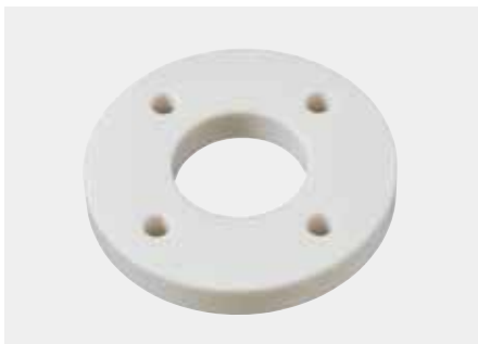
ジルコニア Zirconia ・平行度 Parallelism:5 \mu m ・平面度 Flatness:5 \mu m ・表面粗さ Surface roughness:Ra0.5
