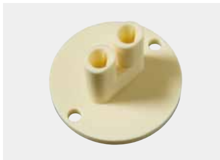
アルミナ Alumina ・平行度 Parallelism:5 \mu m ・平面度 Flatness:5 \mu m ・表面粗さ Surface roughness:Ra0.8
