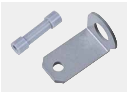
窒化ケイ素 Silicon nitride ・平行度 Parallelism:5 \mu m ・平面度 Flatness:5 \mu m ・表面粗さ Surface roughness:Ra0.5
