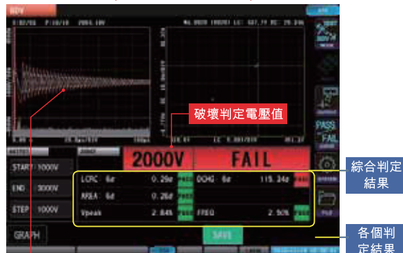
各個判定結果的任一項為 FAIL 時，視為絕緣破壞開始，在那個時間點測試結束。擊穿電壓波形以紅色顯示。
