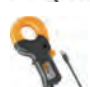
AC/DC 電流探頭 CT6845-05 AC/DC 500A, 鉗式, φ 50mm, DC ~ 100kHz 電源: 使用傳感器單元CT9555 或CT9557
