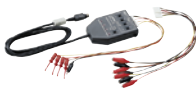
9327 邏輯探頭 4通道.用於檢測電壓/接點信號的ON/OFF(可回應脈衝寬度100ns以上.小型埠)
