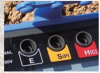
即使端口保護蓋打開時也有IP67安全級別
