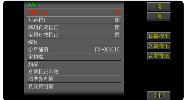
校正 量測待測物之前，需要先做開路、短路、高頻負載校正、及定頻負載校正。
