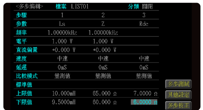
多步測試 多步列表測試自動編成功能，最多 15 組 (可存 50 個編程)。
