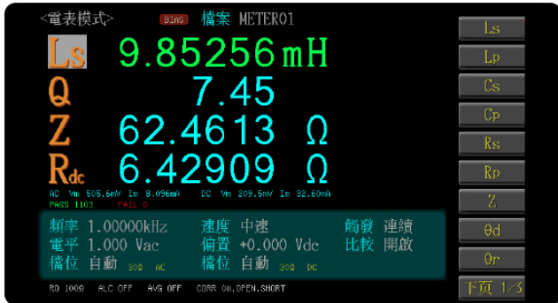
四顯參數 800*400 7 吋彩色螢幕，可以同時設定即顯示四種不同的參數。
